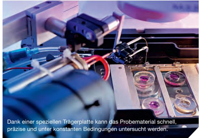
Dank einer speziellen Trägerplatte kann das Probematerial schnell, präzise und unter konstanten Bedingungen untersucht werden.
